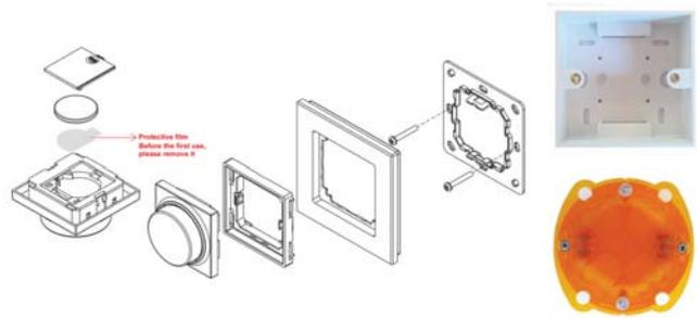
El controlador puede ser instalado en superficie, pegado o atornillado, o empotrado en una caja estándar de 60 mm.
